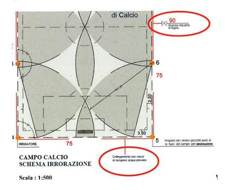
Anche la vasca di recupero acque piovane **NON** è definita graficamente e **NON** è definita la condotta di collegamento con il sistema di drenaggio e **NON** è definito il sistema di pompaggio per l'irrigazione né il suo collegamento elettrico
