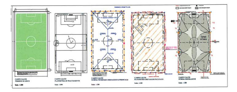
In un unico elaborato sono stati rappresentati: il terreno di gioco calcio, la planimetria di tracciamento, lo schema delle pendenze e del drenaggio superficiale, la planimetria del drenaggio inclinato, lo schema di irrorazione.
